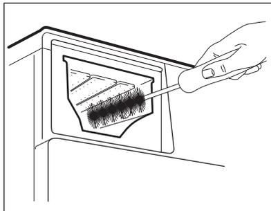
3. Spülen Sie die Waschmittelschublade unter fließendem warmen Wasser aus, um alle Waschmittelrückstände zu entfernen. Setzen Sie nach der Reinigung das Oberteil wieder ein.
