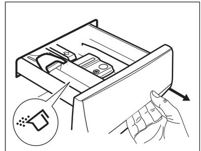
4. Um Flüssigwaschmittel zu verwenden, drehen Sie die Klappe nach unten.
