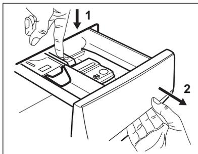
2. Um die Reinigung zu vereinfachen, entfernen Sie auch das Oberteil des Pflegemittelfachs. Stellen Sie sicher, dass alle Waschmittelreste an der Ober- und Unterseite der Aufnahme entfernt wurden. Reinigen Sie die Schubladenaufnahme mit einer kleinen Bürste.
