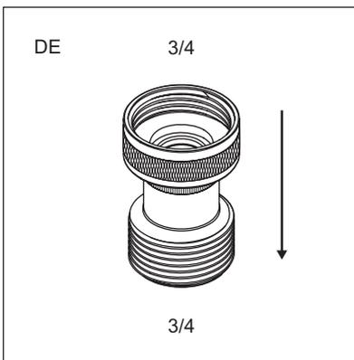
1. Schließen Sie den Wasserzulaufschlauch an der Rückseite der Maschine an.
