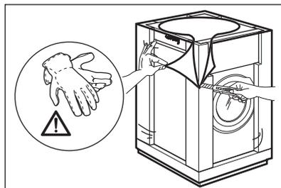
2. Entferne die Karton-Abdeckung und die Styroporverpackungen.
