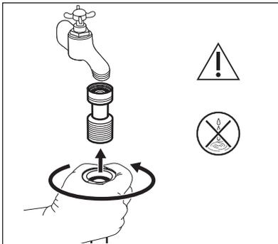
**i** Anforderungen: 3/4-Zoll-Gewinde. Die Flussrichtung wird durch den Pfeil angezeigt.
