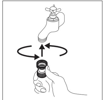
5. Schließen Sie den Zulaufschlauch an das Ventil an. Ziehen Sie die Ringmutter fest, um Leckagen zu vermeiden.
