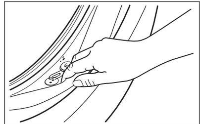
Reinigen Sie sie nach Bedarf mit einer ammoniakhaltigen Reinigungscreme ohne die Oberfläche der Dichtung zu verkratzen.
